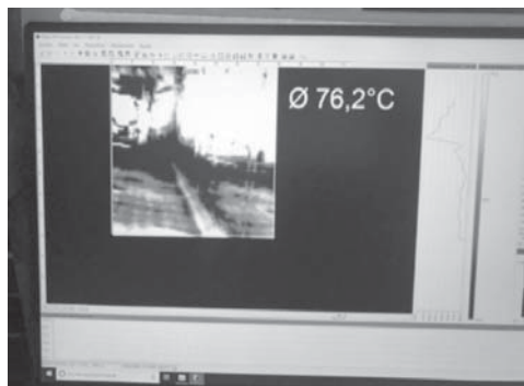
Figura 2: Controllo della temperatura della superficie del rimorchio mediante una termocamera
