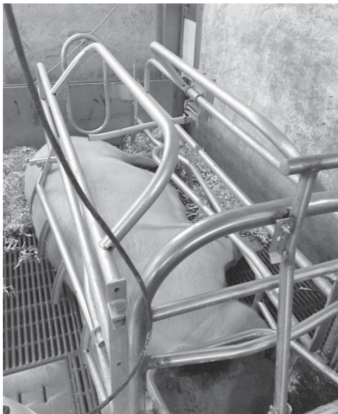
Figura 2. Esempio di gabbia parto con meccanismo “up and down”. È possibile vedere il sensore meccanico (giallo) che attiva il meccanismo di innalzamento e abbassamento dell’area della scrofa.
