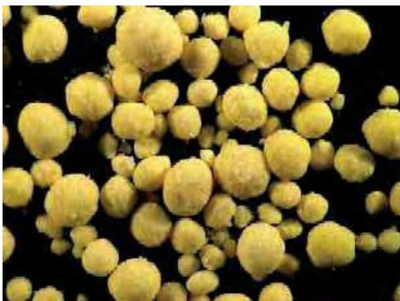
Fig. 2 Micro granuli di amoxicillina (x 40) in una matrice di ricopertura idrofilica (Suramox®/Stabox®-Virbac): mediana dei diametri delle particelle 380  $\mu\text{m}$
